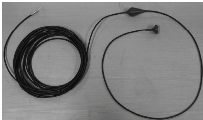
图 8 拖曳接收换能器样机实物
