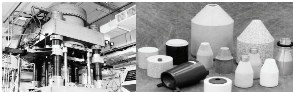
图 1 美国衣阿华陆军弹药厂的 800 t 压药机(左)及精密压制战斗部药柱毛坯 [7]
