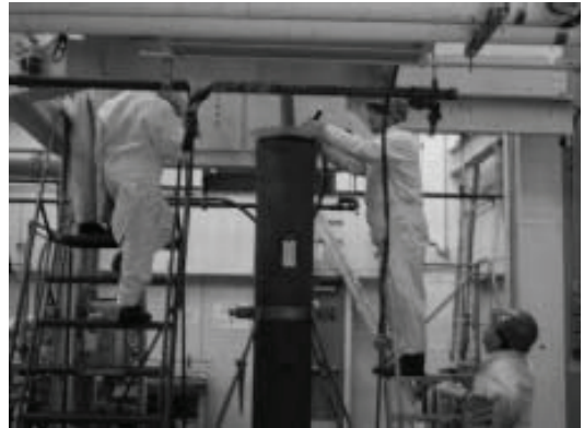
图 4 美国 BLU-118B 炸弹浇注 PBXIH-135 炸药 [10]
