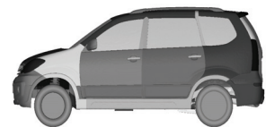
(b) 基础模型+封闭进气格栅
