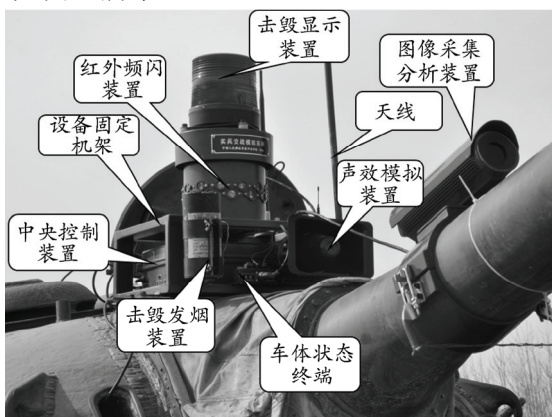
图 3 实兵交战模拟终端安装实景图
