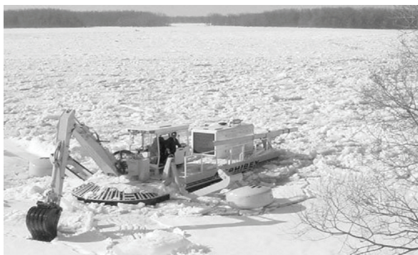
(a) 加拿大 Amphibex 挖掘机靠自身重量压碎冰盖
