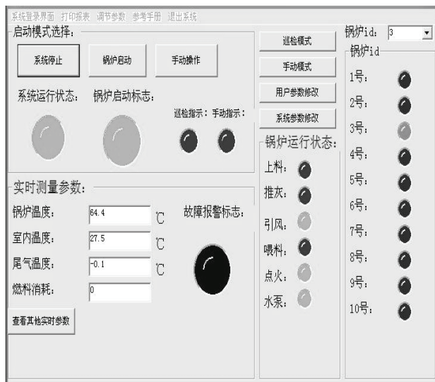
图6 锅炉监控上位机界面
