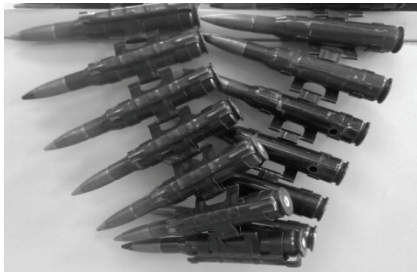
图 3 过渡仓“弹靠弹”现象
