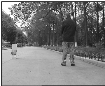
图 23 多层激光测距仪和 CCD 摄像机空间配准
