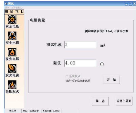
图 10 电阻值测试界面
