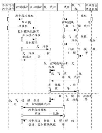
图 4 多线程等效飞行控制软件时序图
