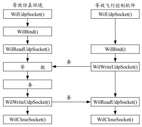
图 2 UDP 通信协议模型
