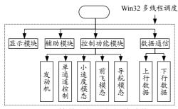
图 1 等效飞行控制软件结构
