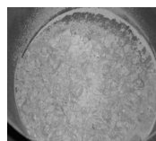
图 5 破碎后 TNT 冒口药
