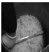
图 7 破碎后 B 炸药冒口药
