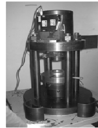
图 7 发射装药动态挤压破碎试验装置
