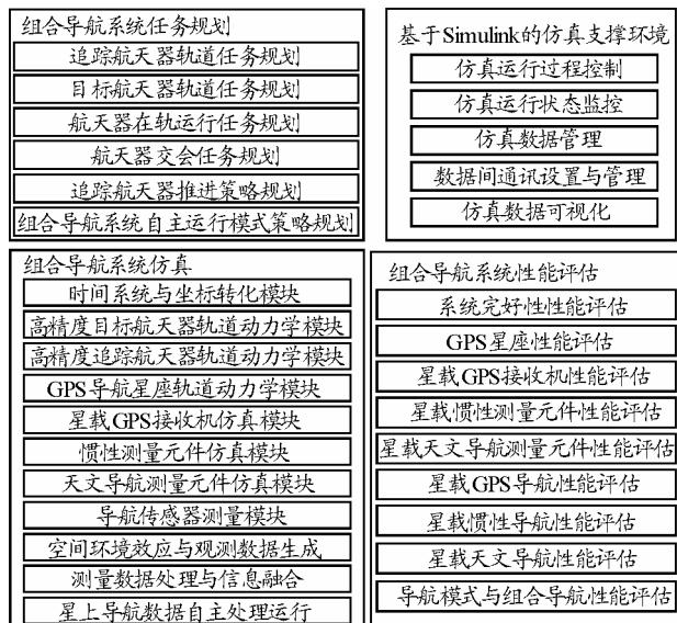
图 1 GPS/SINS/CNS 组合导航仿真系统
