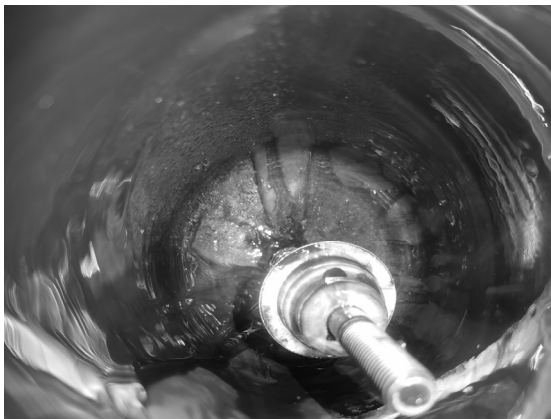
图 7 拆检后发现机油滤大量金属沫
