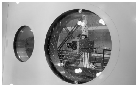
图 2 光学玻璃裂纹
