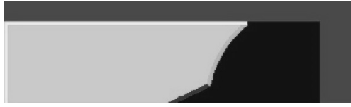
图 4 组合药型罩有限元模型
