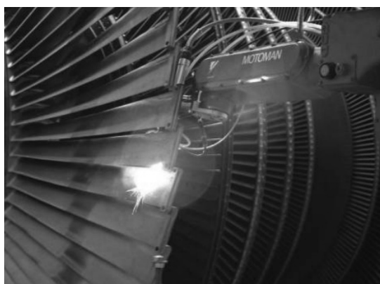
图 1 LMD 修复涡轮叶片 [14]
