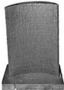
(a) 通过 DED 工艺生产的涡轮叶片
