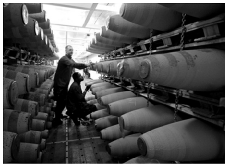
图 1 国外海军上舰弹药进行堆垛贮存
