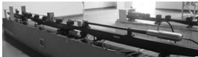
图 2 Hopkinson 压杆试验装置
