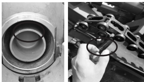
图 6 弹链链头和弹尾一侧痕迹
