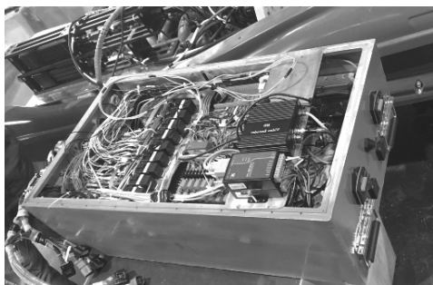
图4 USV 航行控制系统的硬件组成
