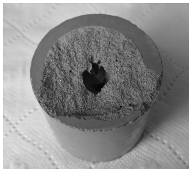
图 9 带气孔疵病药柱
