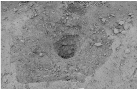
图 6 稀土药型罩(1-3#)侵彻试验结果
