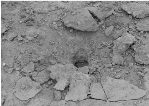
图 4 钛合金药型罩(1-1#)毁伤效果
