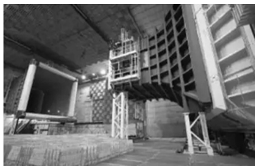
图 3 DNW 风洞消声室
