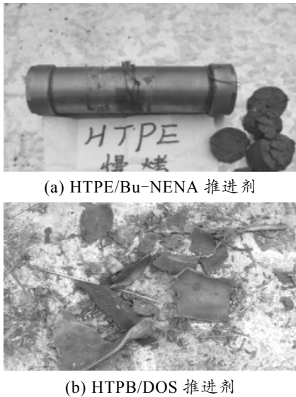
图 2 相同能量水平推进剂的慢速烤燃试验结果
