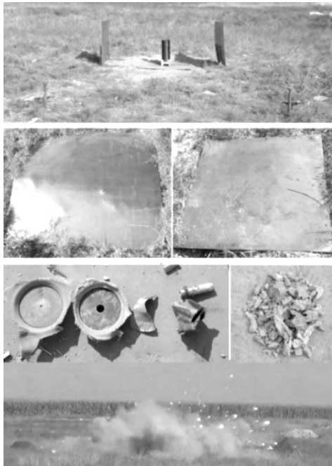
图 5 HTPE 推进剂的聚能射流冲击试验结果
