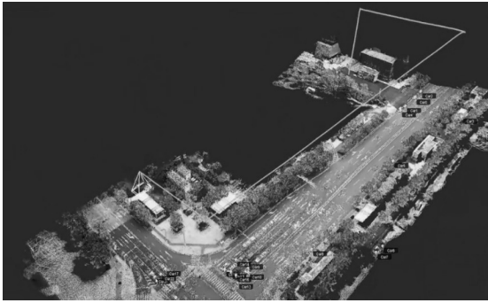
图 2 无人机巡测实时建模效果
