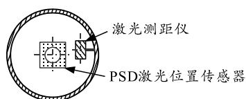
图 8 激光测距仪与 PSD 位置偏差
