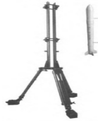
图 1 TK-1A 人影探测火箭和发射架
