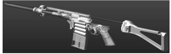
图 17 首发弹闭锁前冲过程
