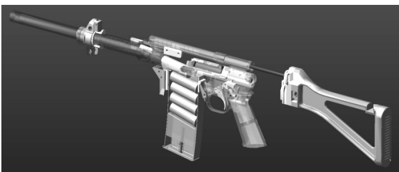
图 16 首发弹推弹进膛过程
