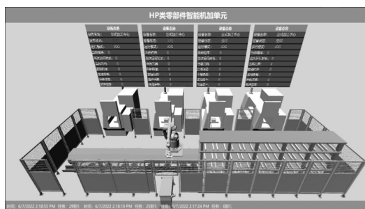
图 13 机加单元 3 维可视化监控效果
