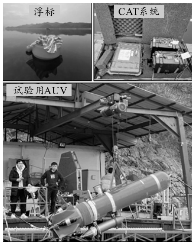
图 5 CAT 系统实际布放情况和试验用 AUV
