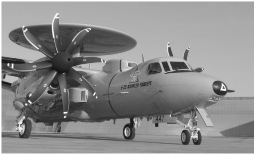
图 1 顶部加装圆盘形天线罩方式
