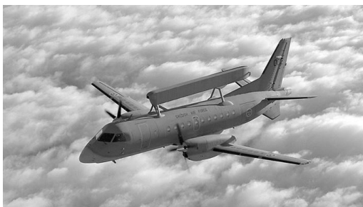
图 2 采用顶部加装平衡木天线罩方式
