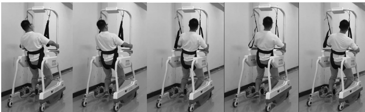
图 17 康复机器人侧向大冲击实验
