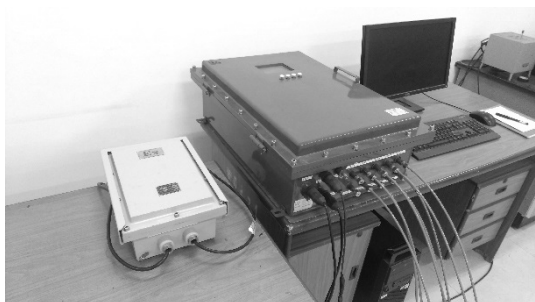
图 4 油库油气浓度在线安全监测预警系统
