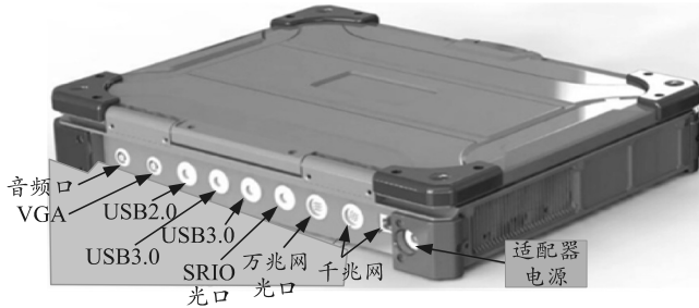
图 3 多接口加固笔记本后面设计
