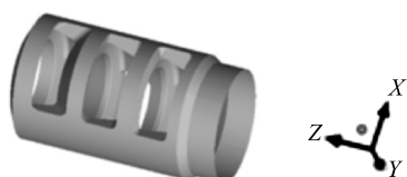
图 1 炮口制退器 3 维模型
