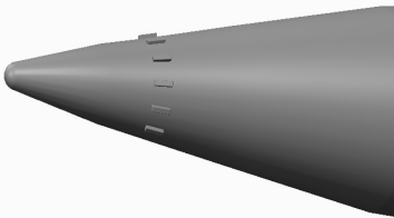
图 3 加装微气泡致动器的弹头
