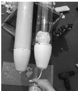
图 5 填充浮筒里面发泡胶
