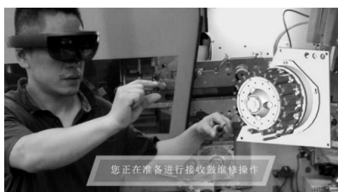
(a) 启动 PTS70 卷接机接收鼓维修
