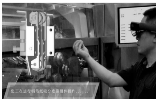
(a) 操作 GDX2 包装机铝箔纸吸分皮带
