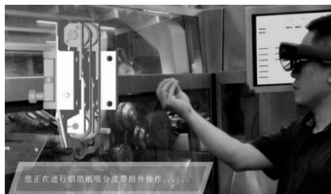
(b) 检验 GDX2 包装机铝箔纸吸分皮带
