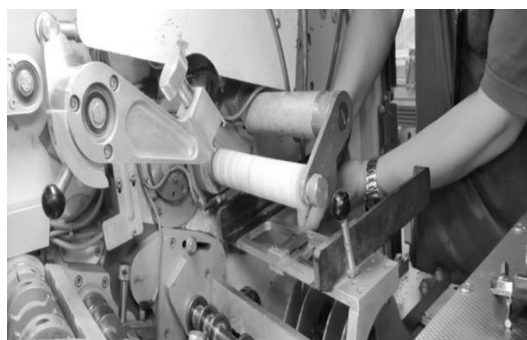
(a) GDX2 包装机更换包装条盒拍板
