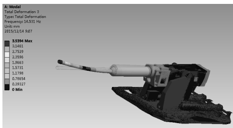
(a) 有限元计算 3 阶振型
