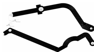
图9 机械臂载荷及边界条件施加
