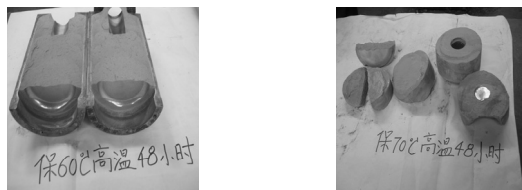
(a) 60 °C 保温后药柱剖切 (b) 70 °C 保温后药柱剖切
