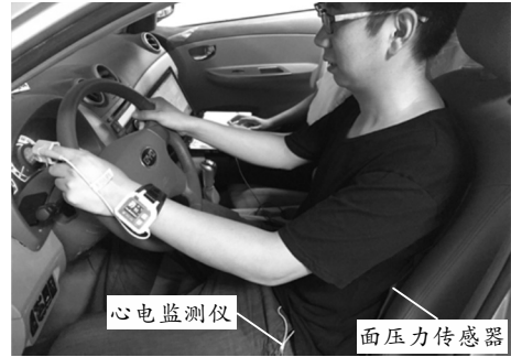
图 5 测试人员及仪器安装情况
