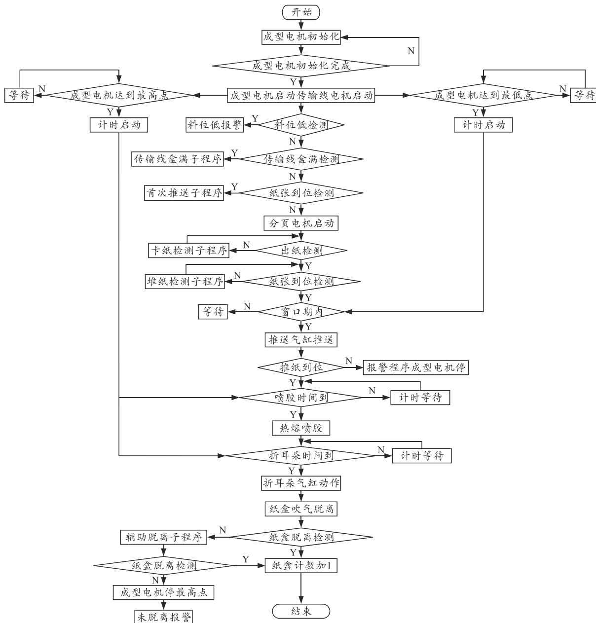
图 9 纸盒成型机工作流程
