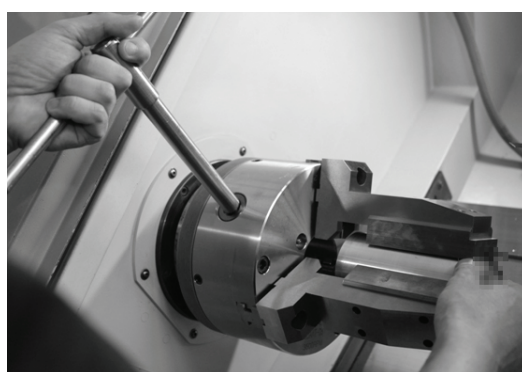
图7 安装薄壁壳体装药件试验件
