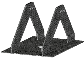
图 4 大臂的有限元模型
