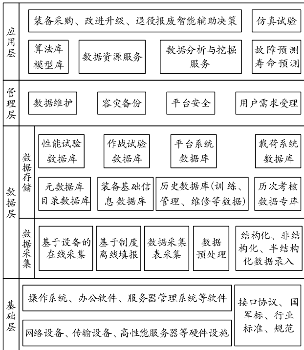
图 2 在役考核数据采集管理平台架构设计
