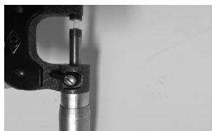
图 3 螺旋测微仪测量药柱长度
